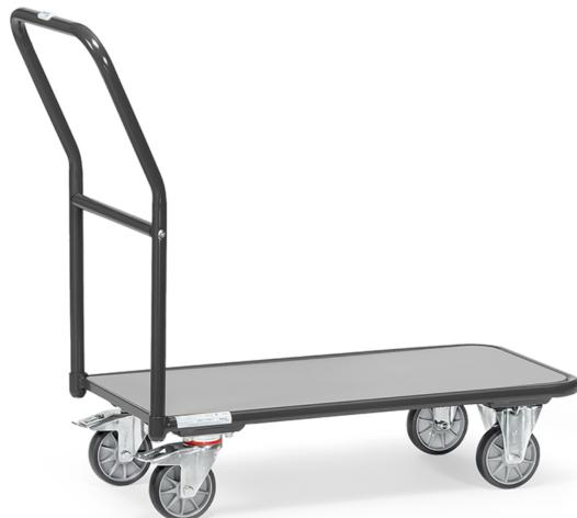
Stahlrohr, Schweißkonstruktion, pulverbeschichtet, anthrazitgrau RAL 7016. Plattform Holzwerkstoffplatte, Oberfläche mittelgrau. 2 Lenk- und 2 Bockrollen, TPE-Bereifung, Nabensicherung. Feststeller an den Lenkkästen, gemäß der Europäischen Norm EN 1757-3 (Sicherheit von Plattformwagen).
