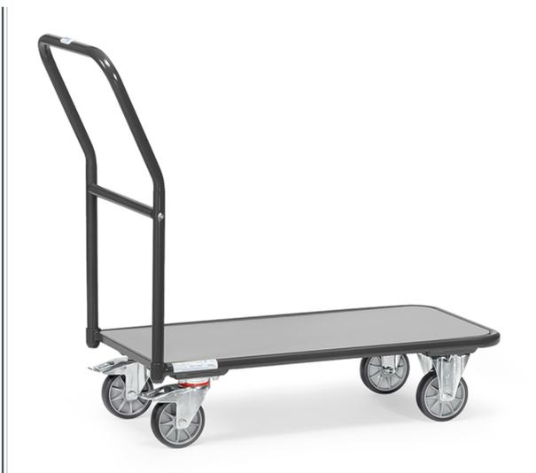
Stahlrohr, Schweißkonstruktion, pulverbeschichtet, anthrazitgrau RAL 7016. Plattform Holzwerkstoffplatte, Oberfläche mittelgrau. 2 Lenk- und 2 Bockrollen, TPE-Bereifung, Naben mit Rillenkugellager. Feststeller an den Lenkrollen, gemäß der Europäischen Norm EN 1757-3 (Sicherheit von Plattformwagen).
